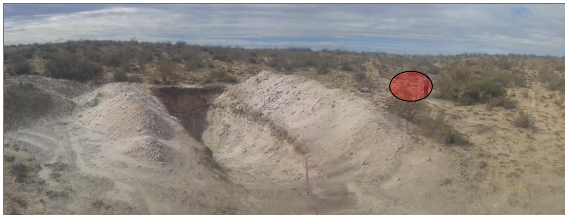
Fotografía 22. Vista de una de las trincheras de exploración abiertas en el sector de Pitu y pozo de prueba (en rojo)
