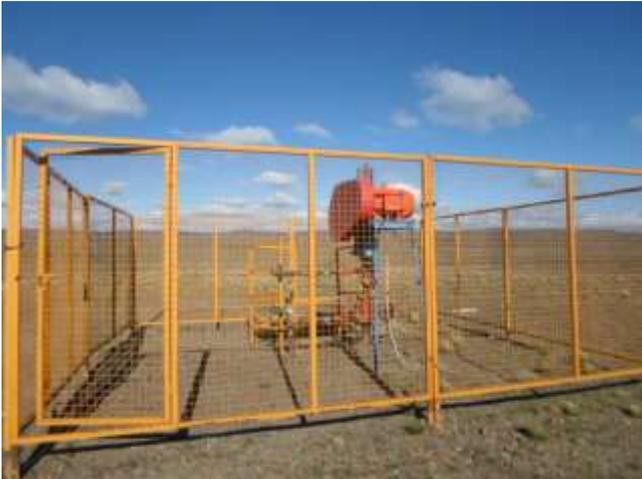
**Foto III.B-24.** Boca de pozo. Sistema de extracción (PCP) instalado y en funcionamiento. El mismo posee cerco perimetral.
