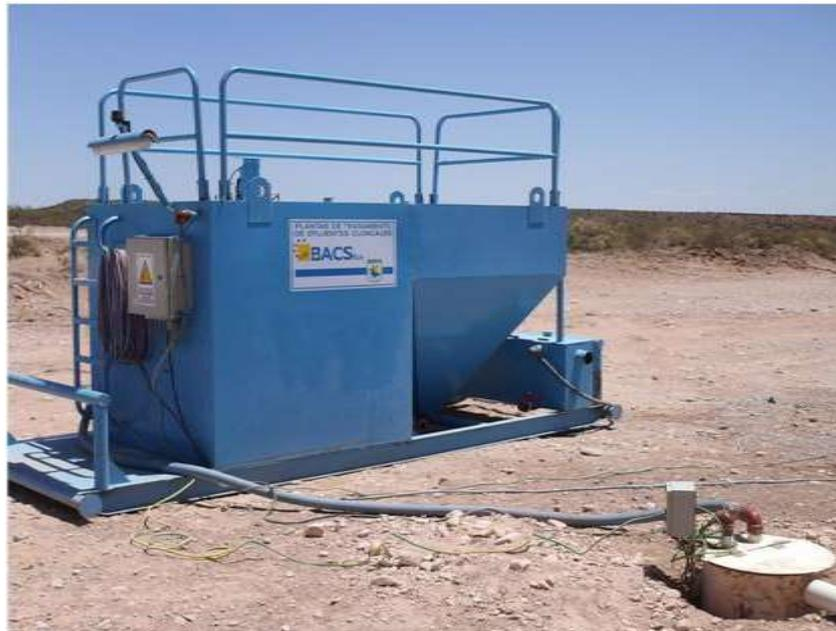
Foto III.B-47. Vista de una Planta de Tratamiento compacta.
