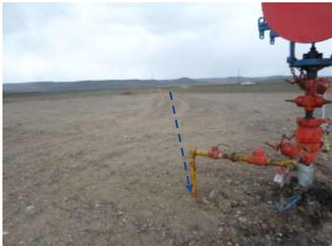
**Foto III.B-48.** Fin de línea de inyección en boca de pozo.
