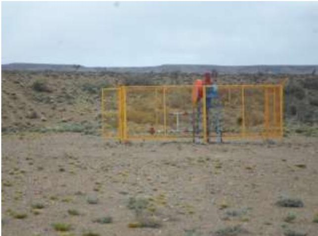
**Foto III.B-58.** Boca de pozo. Sistema de extracción (PCP) instalado y en funcionamiento. El mismo posee cerco perimetral.
