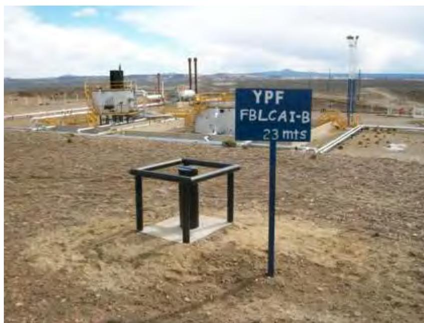
Foto IV.1-11. Freatímetro FBLCaI-B.
