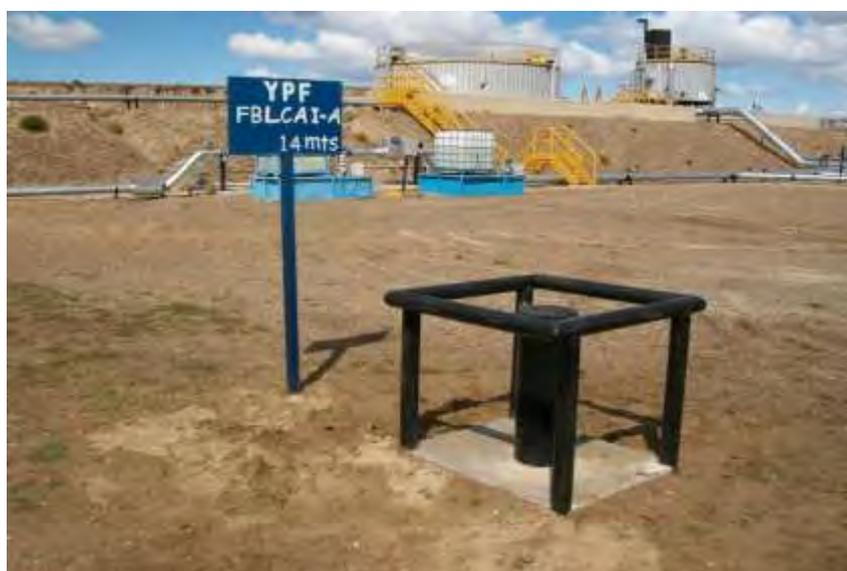
Foto IV.1-10. Freatímetro FBLCaI-A.
