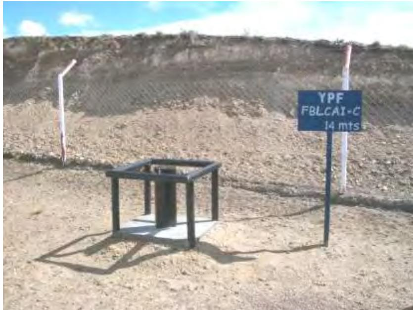
Foto IV.1-12. Freatímetro FBLCAI-C.
