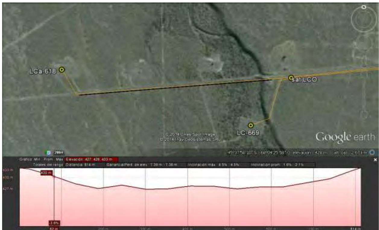
**Figura IV.1-8.** Perfil topográfico Oeste-Este de la línea de inyección desde el satélite LCO hasta el quiebre hacia el NO al pozo LC.a-618, mostrando las paleo-terrazas fluviales en el área donde se encuentra los Pozos.
