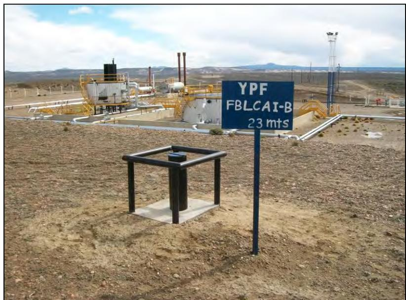
*FOTO 2: Freatímetro FBLCAI-B, ubicado 25 metros al sureste de la Batería, fuera del predio de la misma.*
