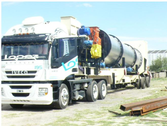
**Imagen 5.** Horno de idénticas características al que se instalará en la planta preparado para despacho sobre camión. Imagen suministrada por el proveedor.
