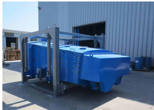
**Imagen 6. Vistas de la zaranda vibratoria de alta frecuencia. Fotos del fabricante**
