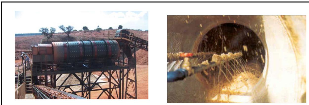
**Imagen 1. Cilindro Lavador.** Las imágenes corresponden a instalaciones similares a las que se proyectan instalar.
