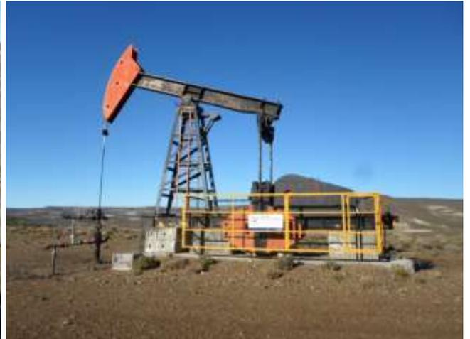
**Foto III.B-12.** Sistema de extracción (AIB) instalado y fuera de servicio.
