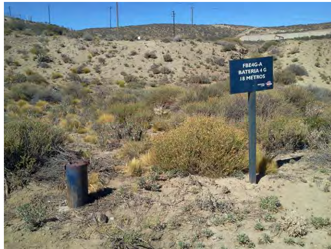
FOTO 1: Frentómetro FBE4G-A, ubicado aguas abajo de la pileta de emergencias de la instalación.
