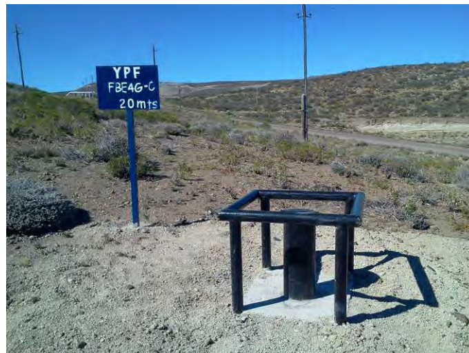
FOTO 4: Freatímetro FBE4G-C, ubicado a unos 80 metros al noroeste de la zona de tanques de la batería, fuera de su predio, aguas abajo respecto del sentido estimado de flujo de aguas subterráneas
