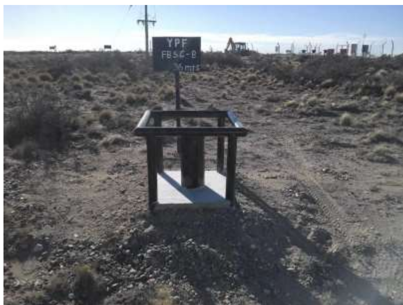
Foto IV.1-9. Freatímetro FBSC-B ubicado a aproximadamente 34 m al Oeste del cerco perimetral de la instalación, fuera de su predio.
