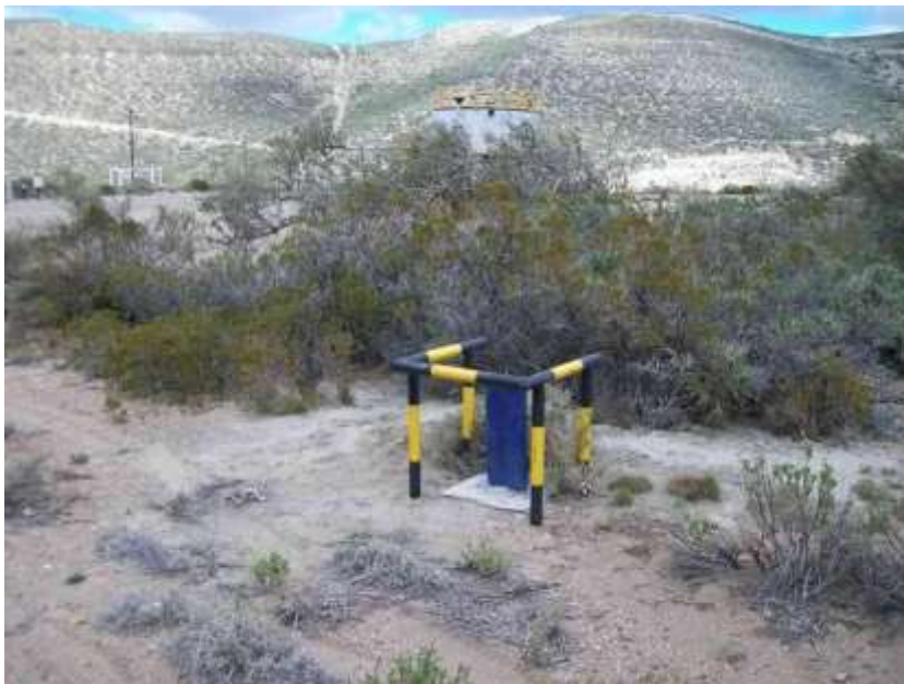
Foto IV.1-12. Freatímetro FBLB63-B, ubicado al Norte de la instalación.
