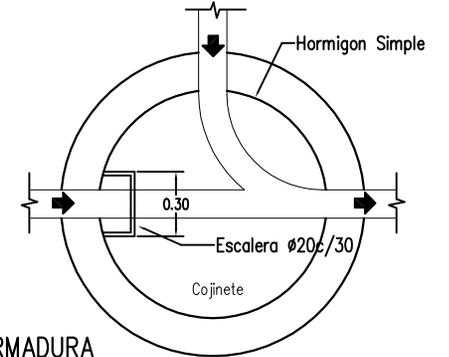
DETALLE DE ARMADURA TAPA DE HORMIGON ARMADO
