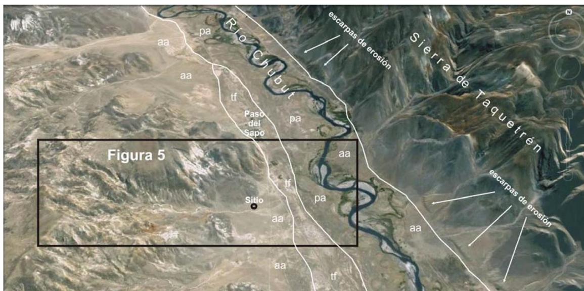
Figura 6: Entorno de la localidad de Paso del Sapo y del sitio escogido para construir la planta de tratamiento. Se indican los principales subambientes y elementos geomorfológicos.
