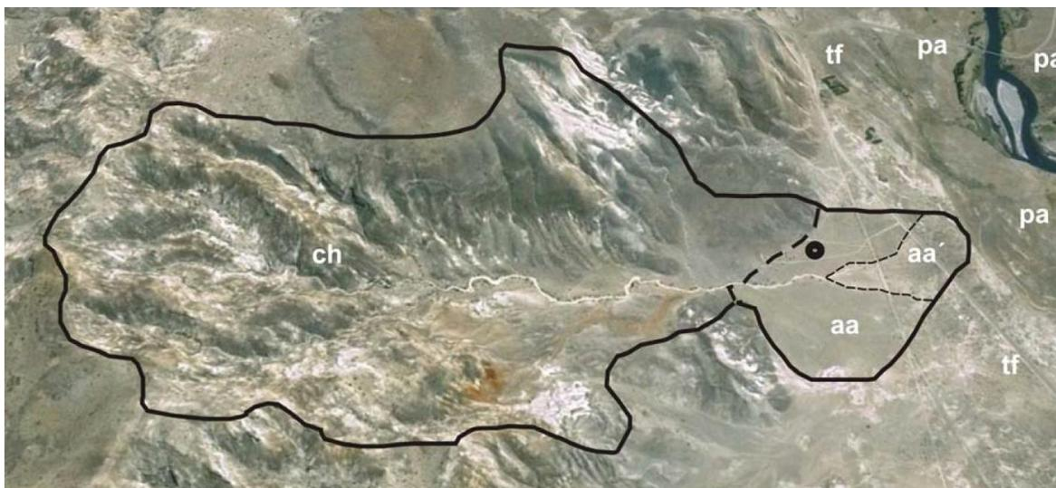
Figura 9: Límites de la cuenca hídrica donde se proyecta instalar la planta de tratamiento de líquidos cloacales. Este sitio está indicado con un círculo negro. Se puede observar la cuenca alta labrada en rocas sedimentarias y piroclástica y la cuenca baja representada por un abanico aluvial que se superpone a las terrazas fluviales del Río Chubut.
