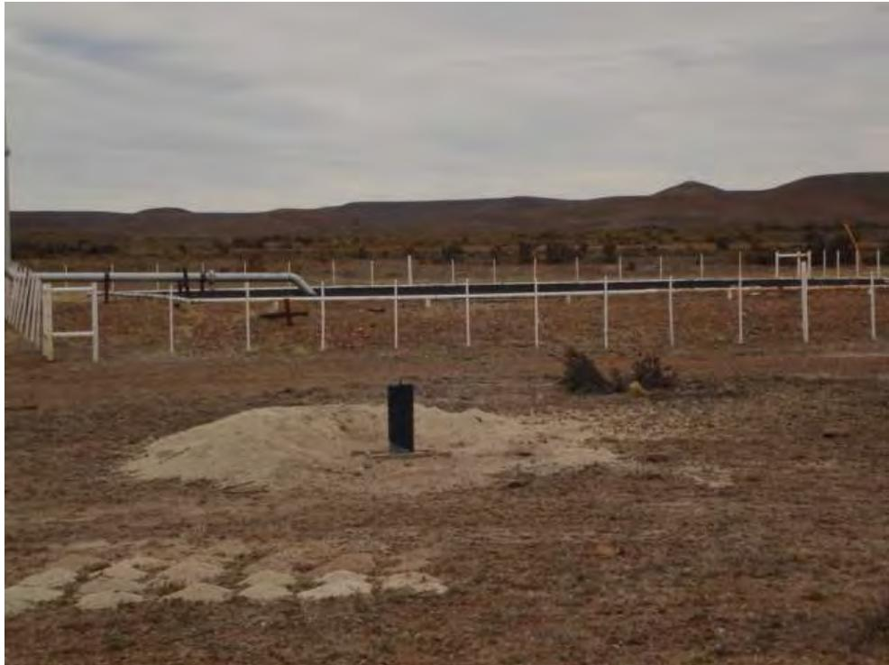
*Foto 1: muestra la posición del freatómetro FLEx5-A agua abajo de la pileta de emergencias del pozo. Se puede observar el material blanquecino extraído durante la perforación del mismo y que corresponde a depósitos tobáceos de la Fm Sarmiento.*
