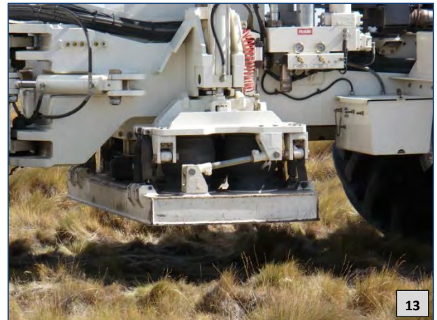
Fotografía 13. Dispositivo emisor del camión vibrador.
