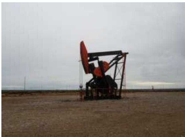
**Foto III.B-27.** Sistema de extracción (AIB) instalado y en funcionamiento.
