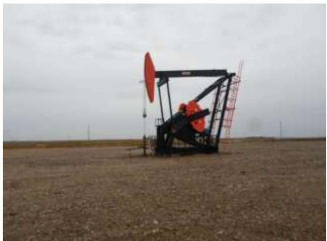
**Foto III.B-123.** Sistema de extracción (AIB) en funcionamiento.
