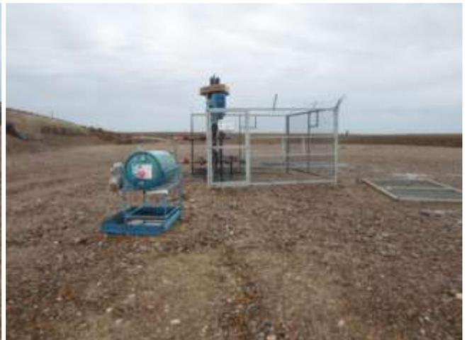
Foto III.B-111. Boca de pozo con sistema de extracción (PCP), cerco perimetral parcialmente instalado y dosificador de productos químicos.
