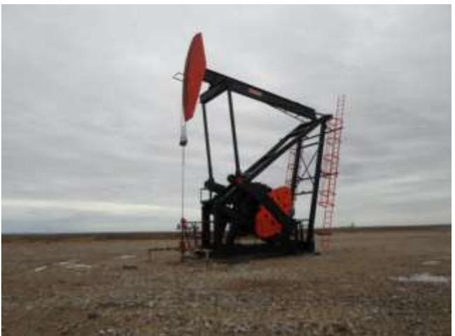
Foto III.B-82. Sistema de extracción (AIB) instalado y en funcionamiento.
