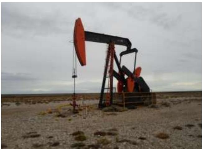
Foto III.B-40. Sistema de extracción (AIB) instalado y en funcionamiento.
