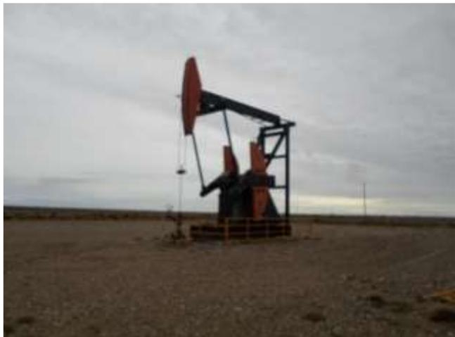
**Foto III.B-15.** Sistema de extracción (AIB) instalado y en funcionamiento.
