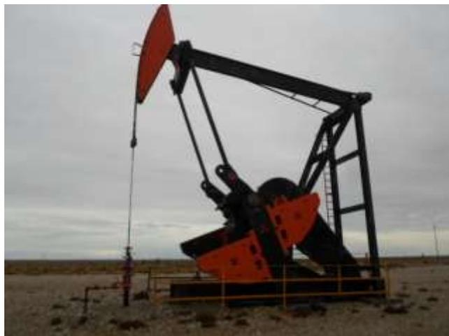
Foto III.B-69. Sistema de extracción (AIB) instalado y en funcionamiento.
