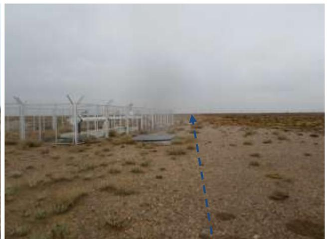
Foto III.B-2. Emplazamiento de acueducto de vinculación por picada existente. Se observa scrapper y cámara de inspección a un lado de la traza propuesta. Foto en dirección NO.
