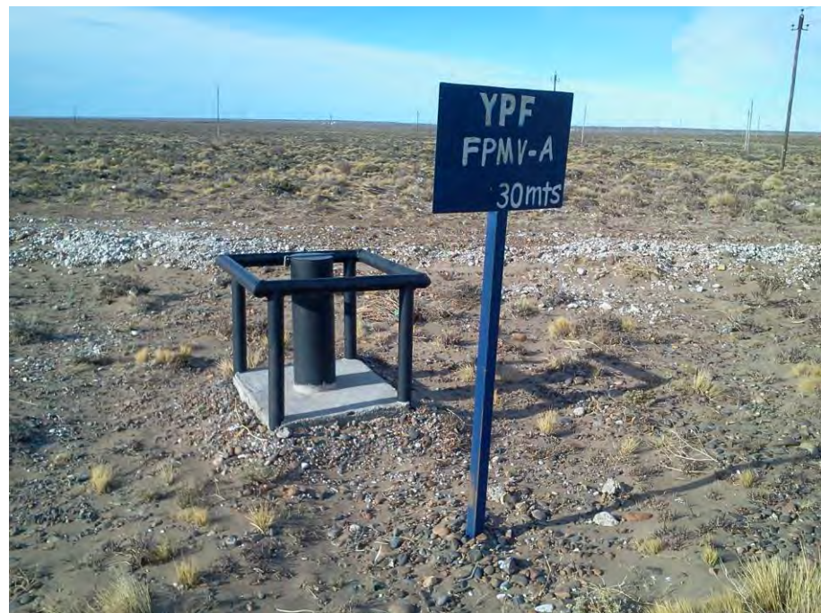
FOTO 2: Freatímetro FPMV-A, ubicado 30 metros al este del obrador de la planta, al este la instalación y fuera de su predio.
