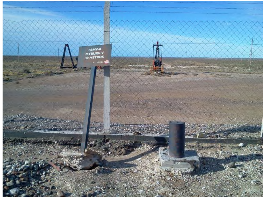
FOTO 1: Freatímetro FBMV-A, ubicado 1 metro del cerco perimetral, dentro del predio de dicha instalación.
