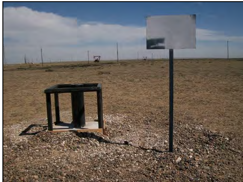
FOTO 2: Freatímetro FBLCII-B, ubicado al sur de la instalación, aguas arriba respecto del sentido estimado de flujo de aguas subterráneas. Su cartel de identificación se encuentra sin pintar.
