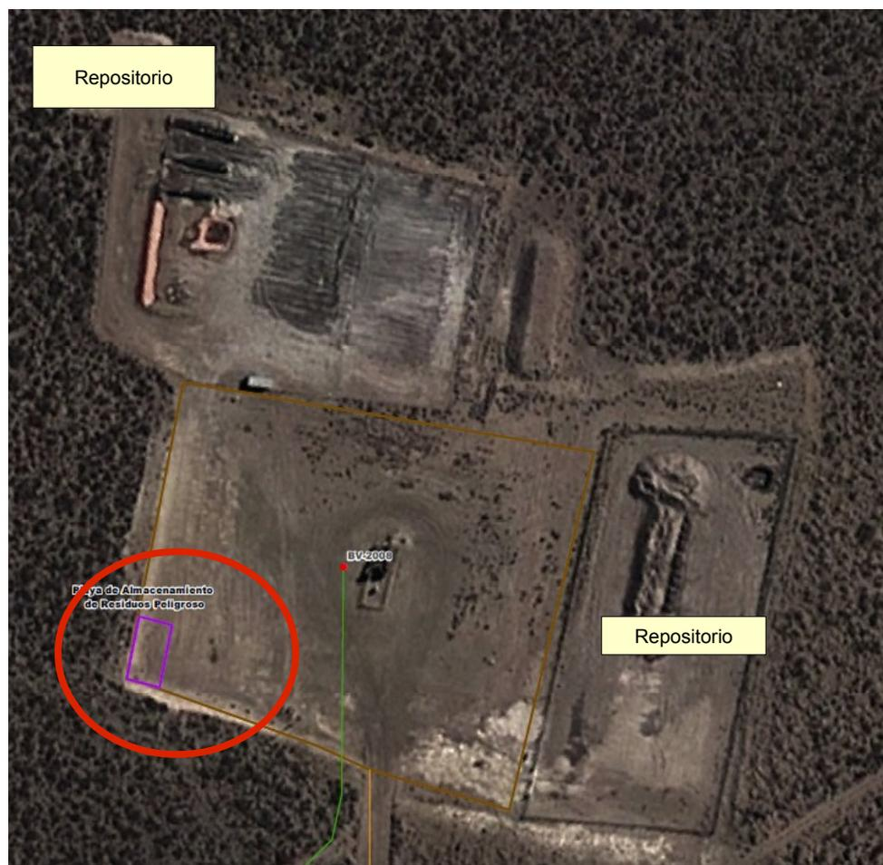
Sitio seleccionado para la construcción del predio de almacenamiento transitorio de Residuos Peligrosos (en color rojo), en vértice SW de locación del pozo BV-2008. Asimismo se observa al N y al E las áreas en las que se encuentran operativos los Repositorios (Repositorio de recortes y lodos de perforación (al N) y el repositorio de suelos empetrolados (al E)).
