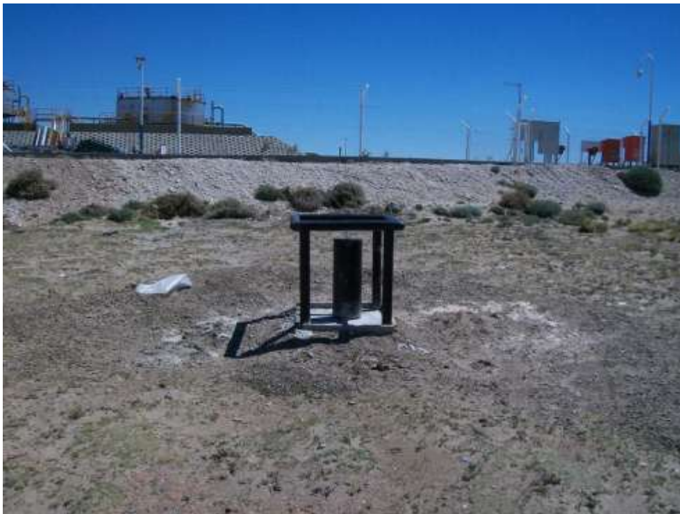
Foto IV.1-4. Freatímetro FBGBKIII-A. No posee cartel de identificación.
